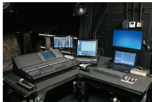
▲スタジオシアターのコンソールはYAMAHA QL5。YAMAHAのコンソールは多くのライブ・ハウスで使われており、乗り込みのエンジニアでもすぐに対応できる点などが主な採用理由だとYSSの佐川氏は言う
