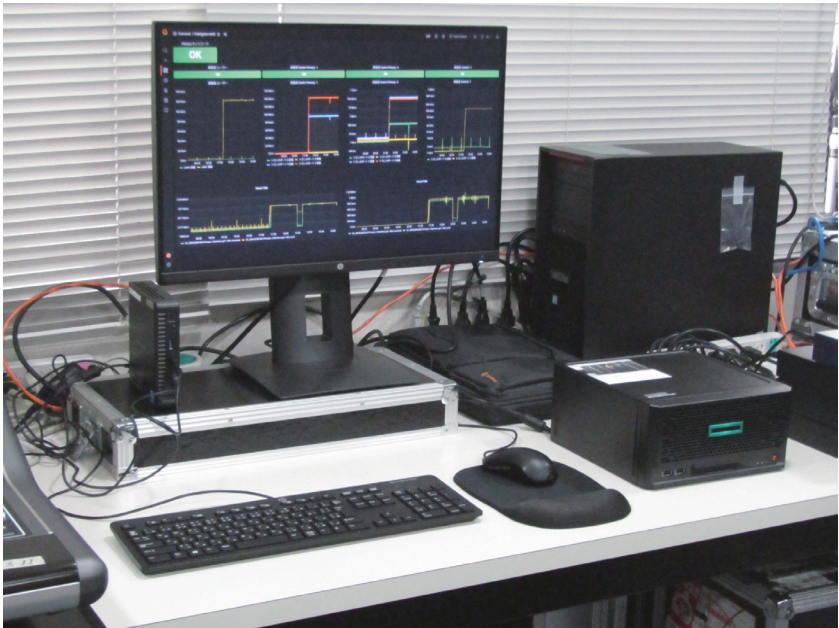
モニターの左下が監視クライアント。右下に監視サーバー
